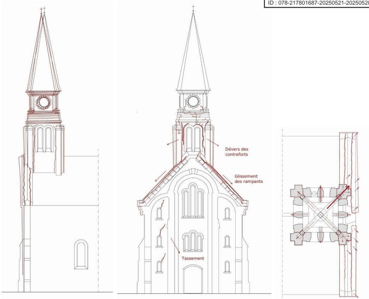
Relevé des déformations du clocher en 2008, élévation et plan, C. Guiorgadzé
